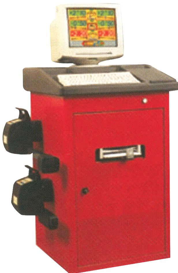
**Apparecchiatura per allineamento ruote di autovetture e veicoli commerciali leggeri**
